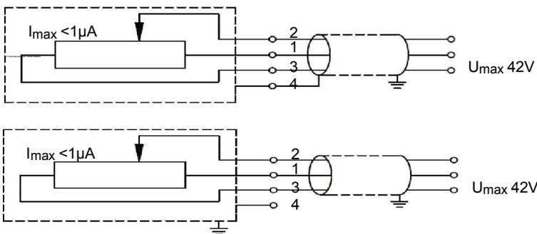
Dargestellte Belegung für ausfahrende Schubstange.
